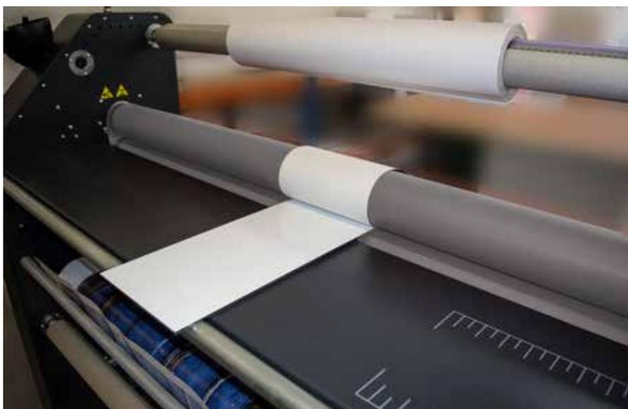
Trennen Sie die erste Hälfte des Abdeckpapiers von dem selbstklebenden Druck und Starten Sie den Kaschiervorgang.
