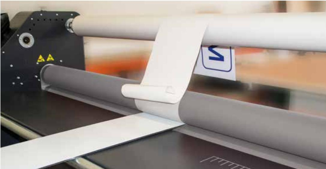
Starten Sie den Kaschiervorgang indem Sie die Platte zwischen die Laminierwalzen schieben und die START -Taste drücken.
